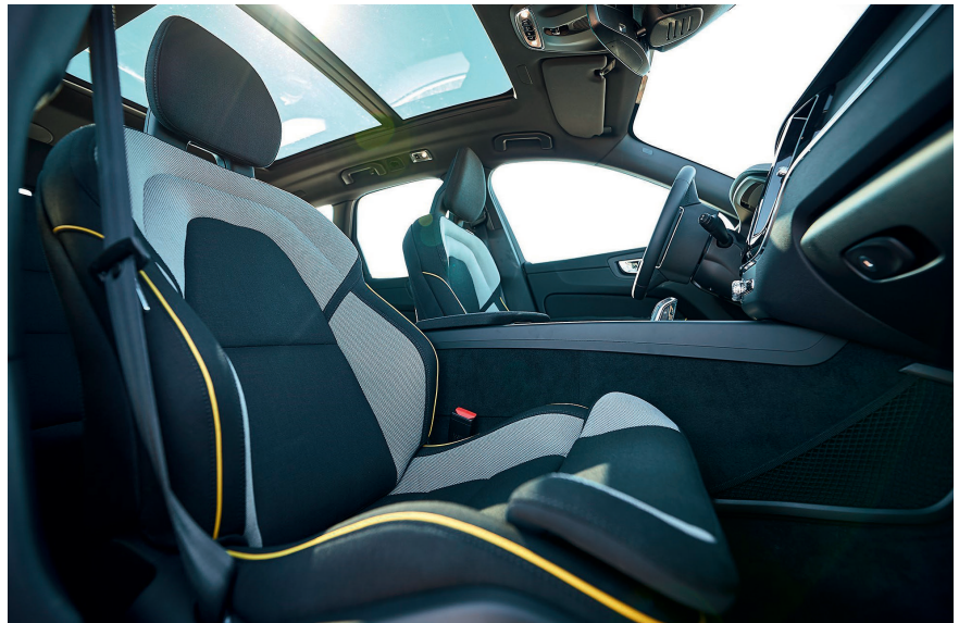
Bild 2. In etwa zwei Dritteln aller Innenraumbauteile konnten recycelte Kunststoffe eingesetzt werden. Unter anderem in den Sitzen kommen PET-Fasern aus Plastikflaschen zum Einsatz (© Volvo Cars)
